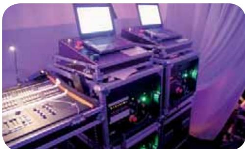
Las diferentes posiciones de los polipastos están determinadas por un rodamiento codificador, y las informaciones son luego registradas y almacenadas temporalmente en el CPU-VS en caso de corte de corriente.
