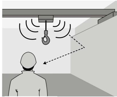
Los polipastos generan un ruido perceptible durante su funcionamiento. El nivel de ruido total que se aprecia en la zona de trabajo es una combinación de fuentes de ruido individuales alrededor del operador. Las fuentes de ruido principales del polipasto proceden de sus componentes, las estructuras que vibran y las superficies reflectantes.
