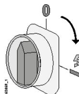
El producto sólo puede accionarse con la alimentación conectada. El propietario de identificar y documentar la ubicación y el funcionamiento del **interruptor general de aislamiento** y debe facilitar esta información a todos los operadores.
