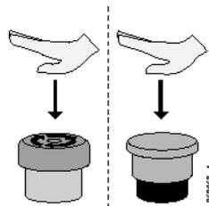
En caso de funcionamiento defectuoso del equipo o en otro caso de emergencia, todos los movimientos pueden ser detenidos de inmediato pulsando el botón rojo de parada de emergencia ubicado en el controlador. Durante el funcionamiento normal, dicho botón no debiera de ser utilizado en vez del uso debido de los controles de dirección. El uso habitual de dicho botón aumenta el desgaste de los componentes del producto y puede hacer bascular la carga.
