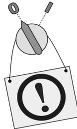
Durante las labores de instalación, inspección y mantenimiento, siga los procedimientos de Bloqueo-Etiquetado según las normas locales y las medidas documentadas al respecto del lugar de trabajo. El propietario debe cerciorarse de que los operadores están plenamente al corriente de los procedimientos pertinentes.
