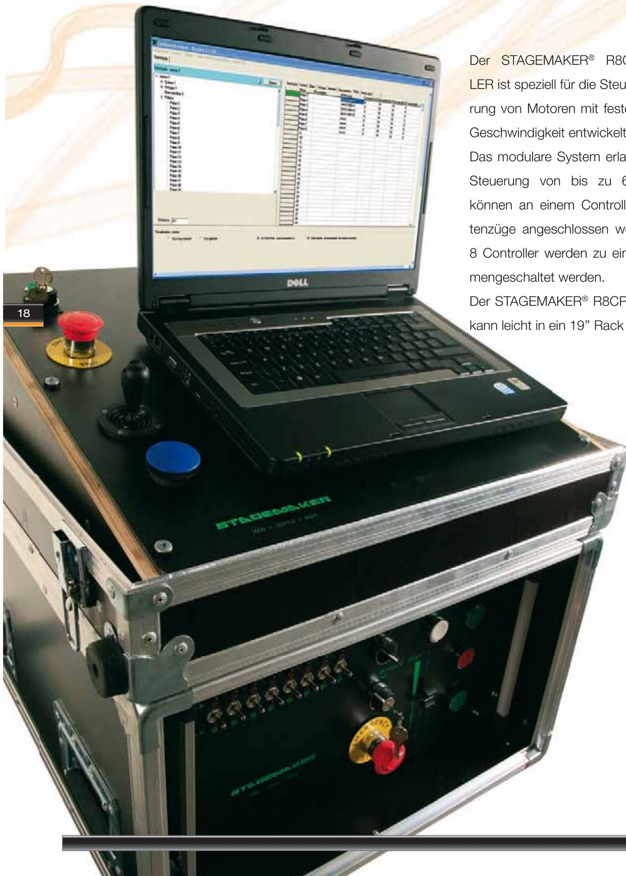
Der STAGEMAKER® R8CPU-VS CONTROLLER ist speziell für die Steuerung und Positionierung von Motoren mit fester, wie auch variabler Geschwindigkeit entwickelt worden.
