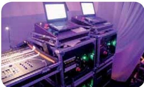
**Einspeisung und Kontrolle** werden im gleichen Gerät kombiniert. Die Züge sind durch ein einziges Multicore-Harting kabel angeschlossen.
