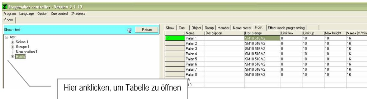
Wählen Sie in der Spalte „Hoist range“ ein Feld an, um eine Liste mit verschiedenen Zugtypen auf der linken Seite zu öffnen. Wählen Sie den Zugtyp aus, der auch an Ihrer Steuerung angeschlossen ist (Siehe dazu auch das Typenschild auf dem Zug). Mit einem Doppelklick auf das Feld hinter dem ausgewählten Zugtyp, fügen Sie den Zugtyp in die Tabelle „Hoist range“ ein.
