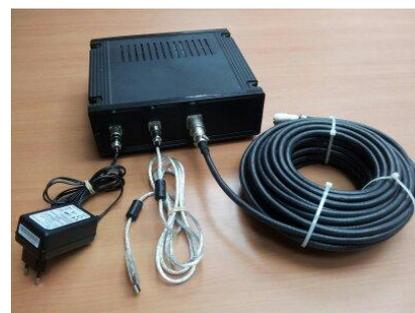
**UNITE DE CONTROLE** – Il s'agit essentiellement d'un PC ou un ordinateur portable, qui contrôle les données reçues du récepteur RADIO CENTRAL, puis traite et les affiche sur l'écran du PC ou ordinateur portable et enregistre les informations sur le disque dur.
